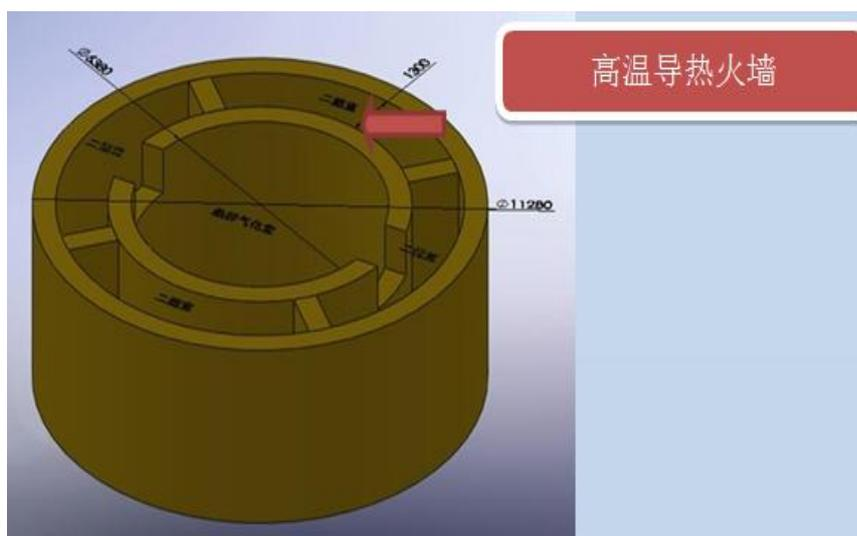
图 4.6-9 (b) 热解气化焚烧炉结构图（俯视图）
