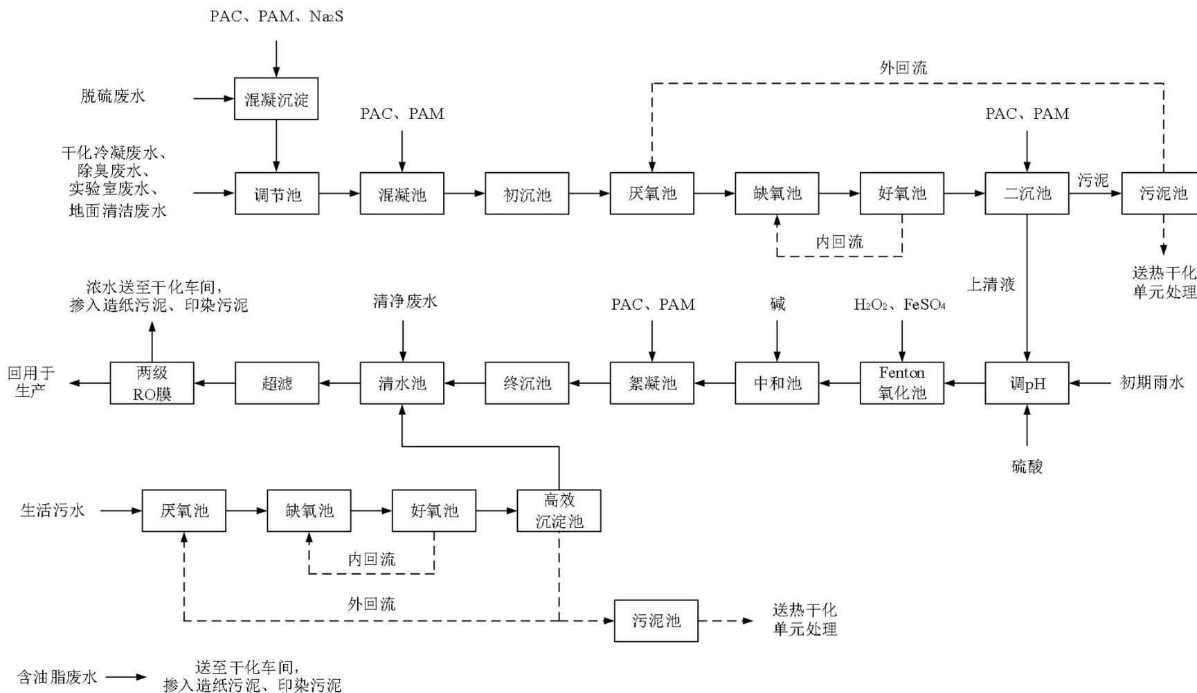
图 8.1-1 生产废水处理工艺流程图
