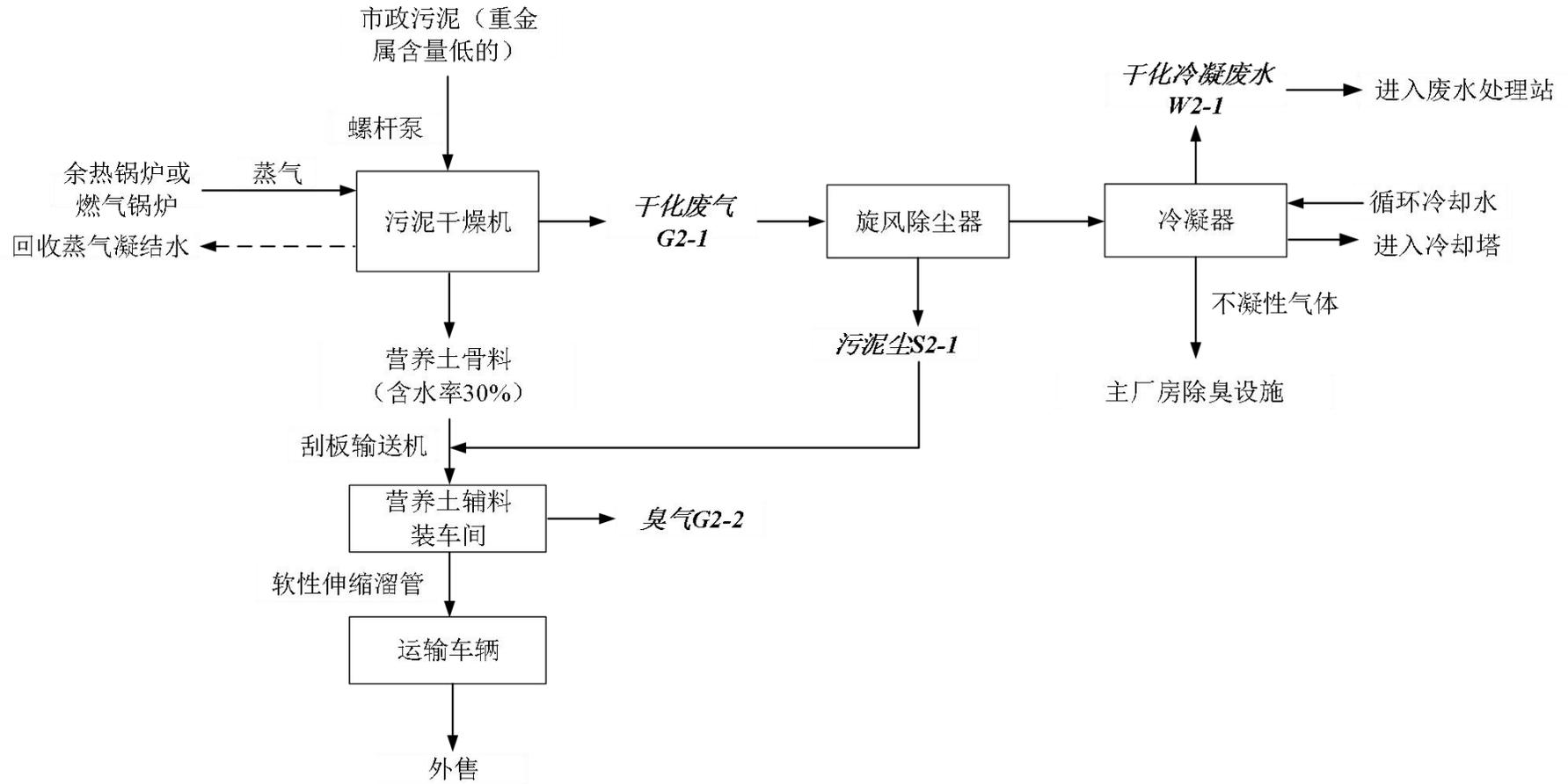
图 4.6-4（d）市政污泥干化处理工艺流程图
