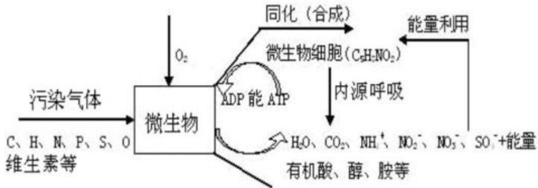
图 8.2-2 除臭的污染物转化机理示意图
