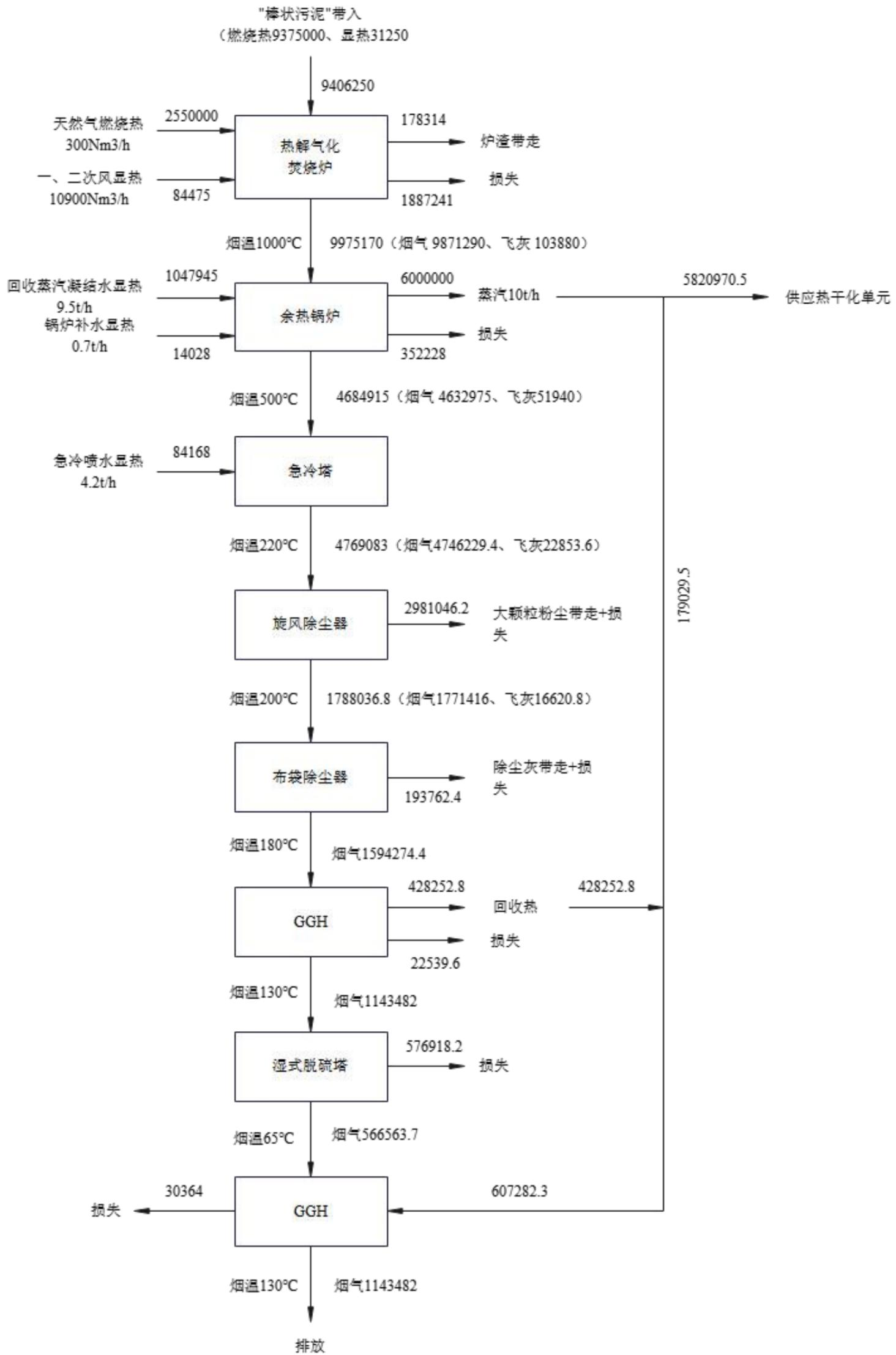
图 4.5-3 重新报批项目热解气化焚烧单元热平衡图 (单位: kcal/h)
