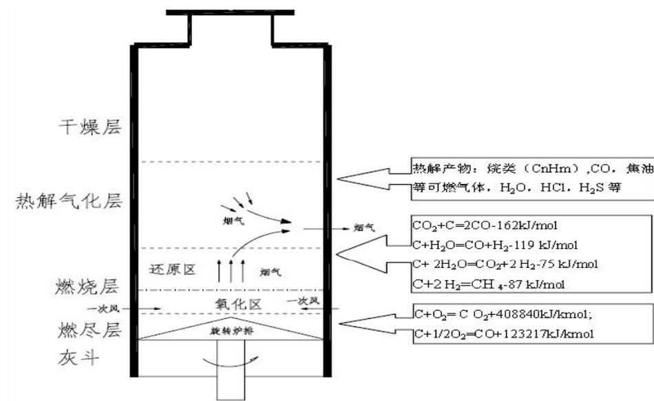
图 4.6-8 热解气化焚烧机理示意图
