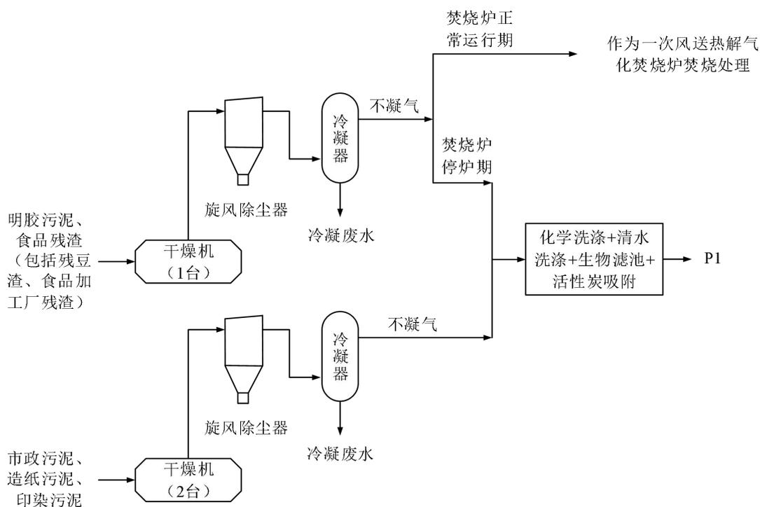
图 4.6-4 干化废气处理工艺流程图
