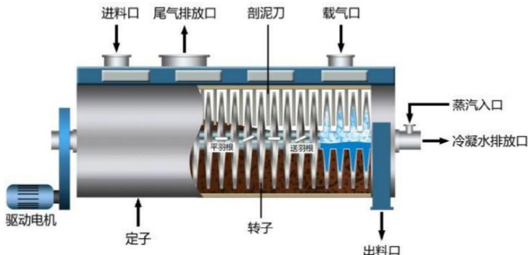
图 4.6-5 (b) 圆盘干燥机工作原理图
