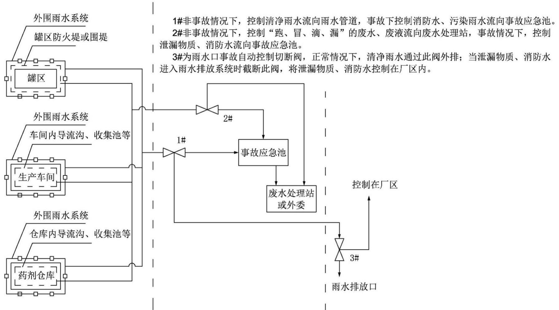
图 7.4-1 防止事故水进入外环境的控制、封堵系统图
