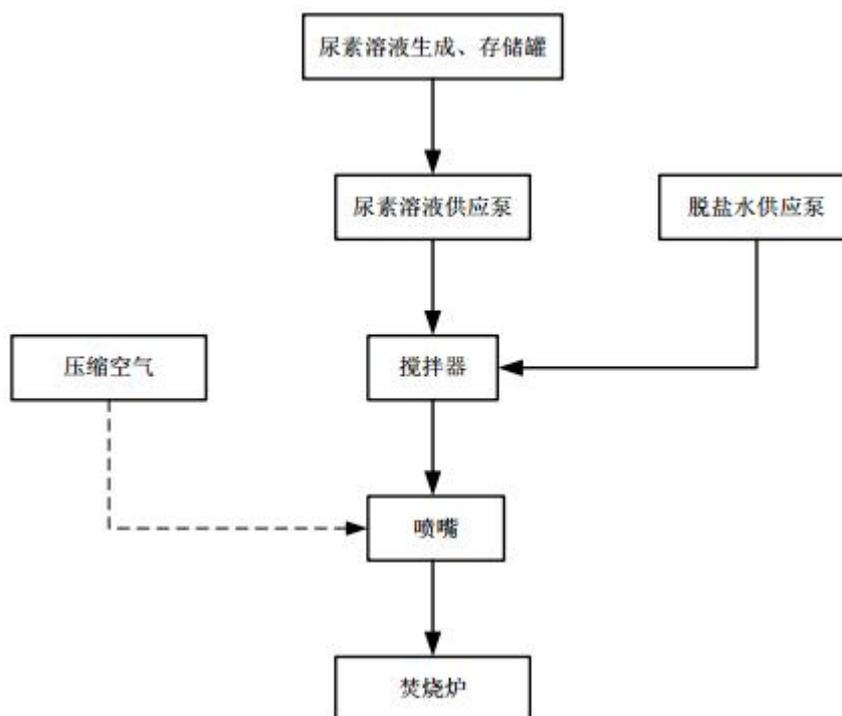
图 4.6-10 SNCR 系统工艺流程图
