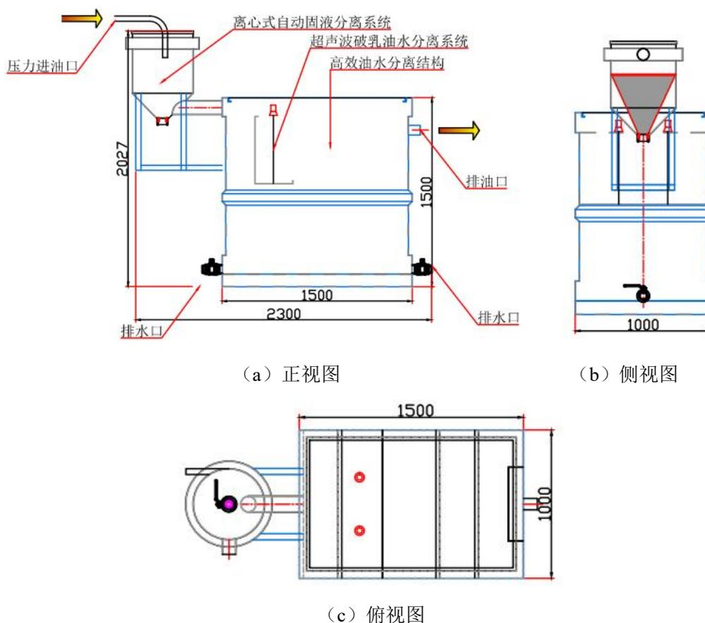
图 4.6-11 高效超声波破乳油水分离装置的结构图
