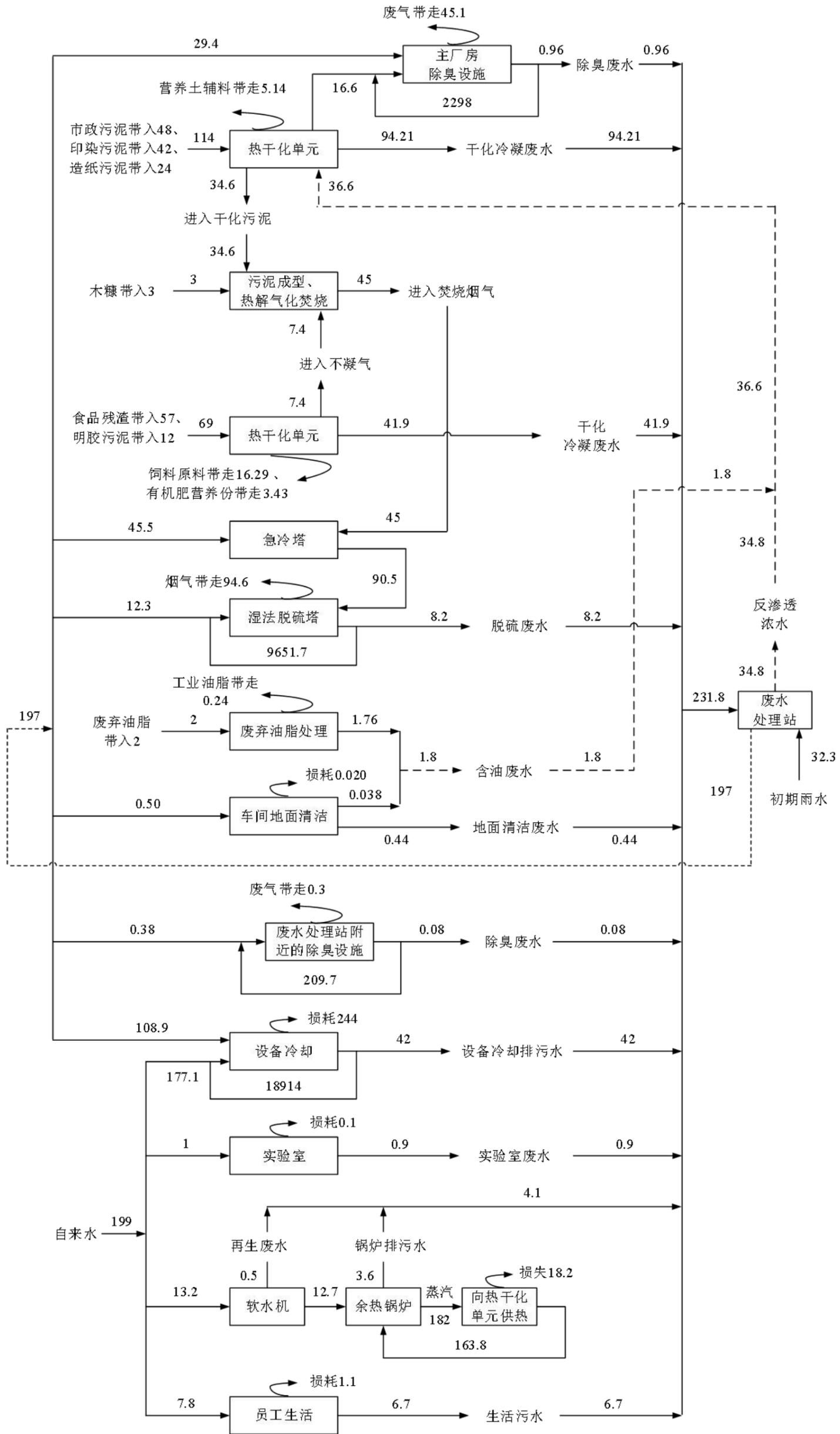
图 4.5-1 (b) 项目水平衡图 (雨天, 单位  $m^3/d$ )
