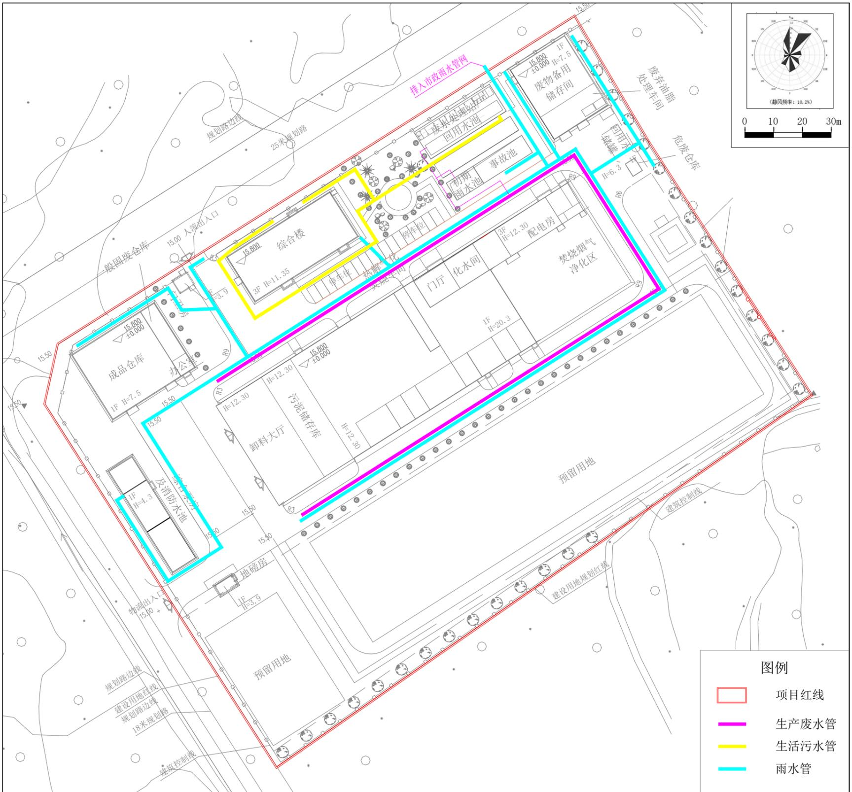
图 4.6-13 项目厂区雨污水管线图
