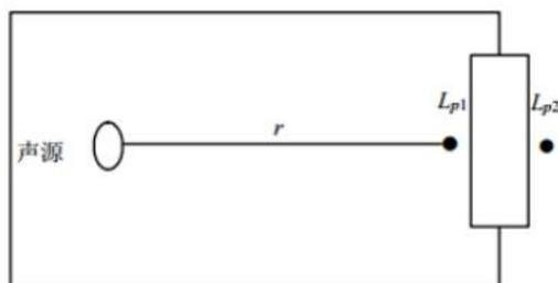
图 6.2-10 室内声源等效为室外声源图例
