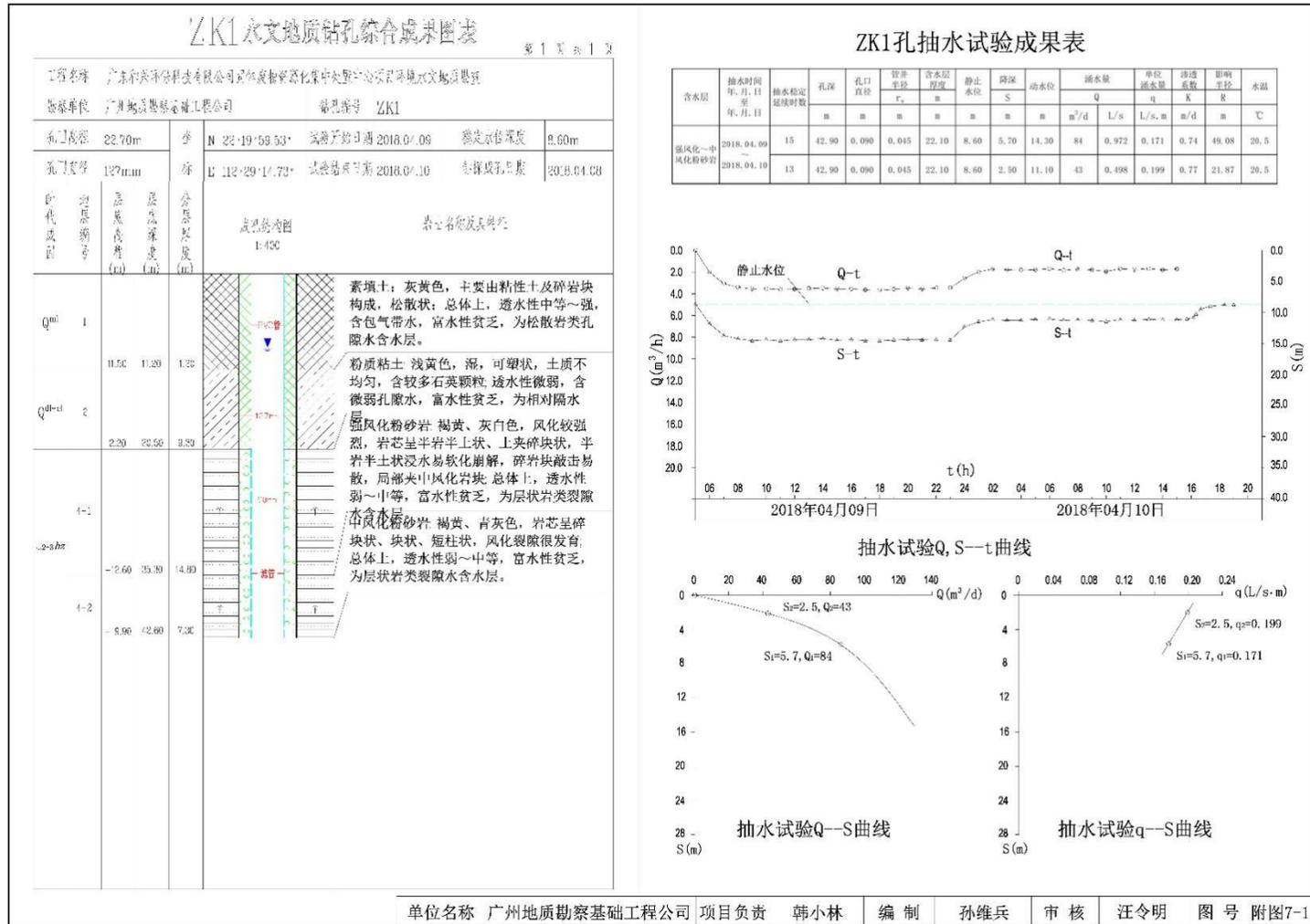
图 5.4-6 水文地质钻孔抽水试验成果图（ZK1）
