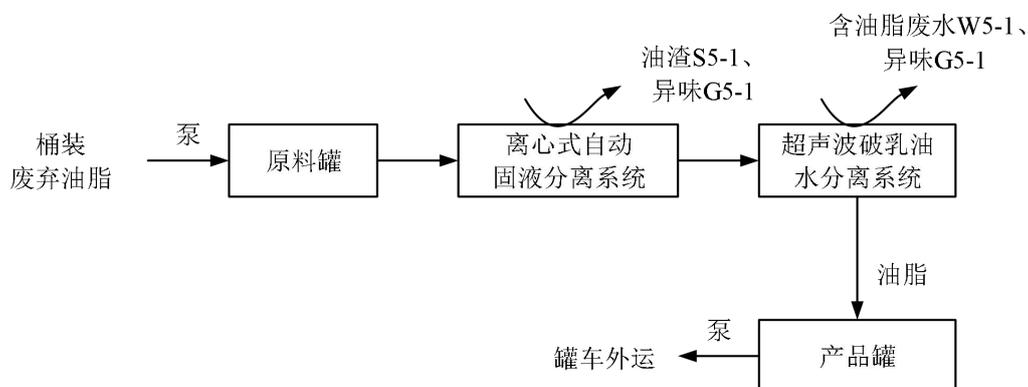
图 4.6-12 废弃油脂处理单元生产工艺流程图
