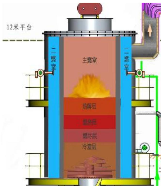
图 4.6-9 (a) 热解气化焚烧炉结构图（剖面图）
