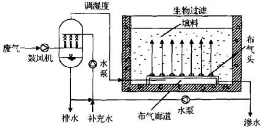
图 8.2-1 生物滤池工艺流程图
