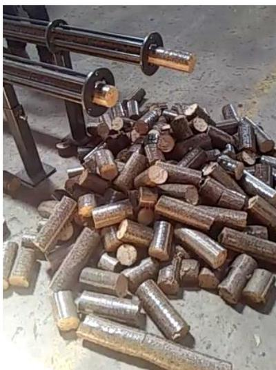
图 4.6-7 生物质固化成型机的产品外形照片
