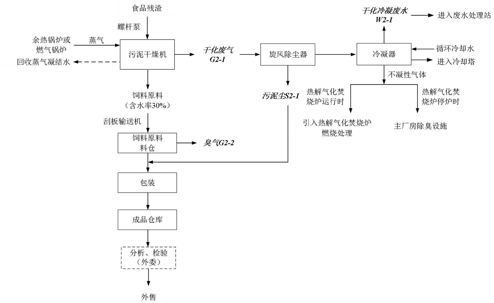
图 4.6-4 (c) 食品残渣干化处理工艺流程图
