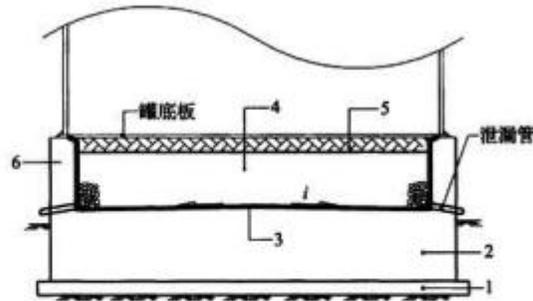
1——混凝土垫层； 2——钢筋混凝土承台； 3——防水涂料层； 4——砂垫层；
