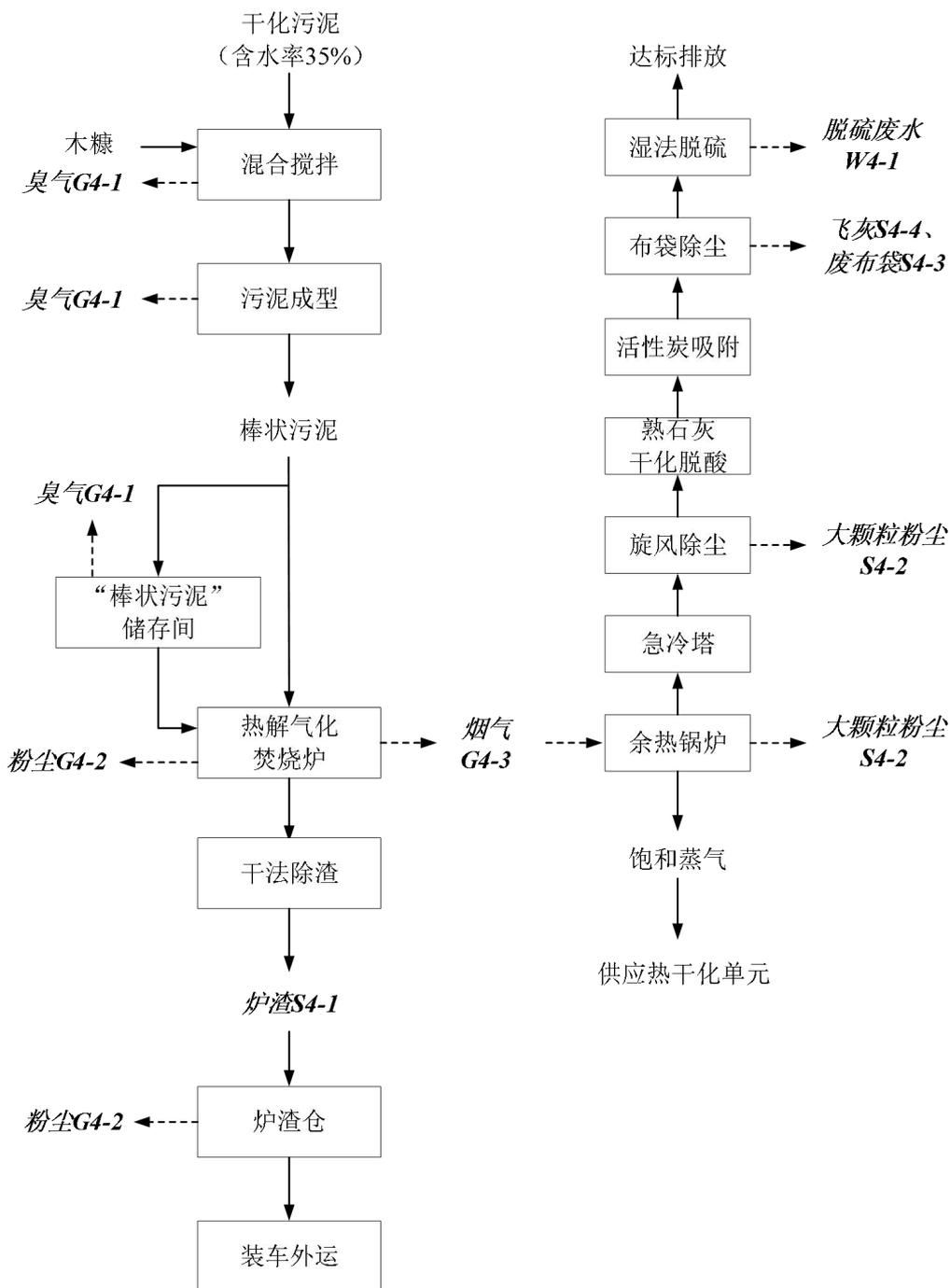
图 4.6-6 热解气化焚烧单元工艺流程图
