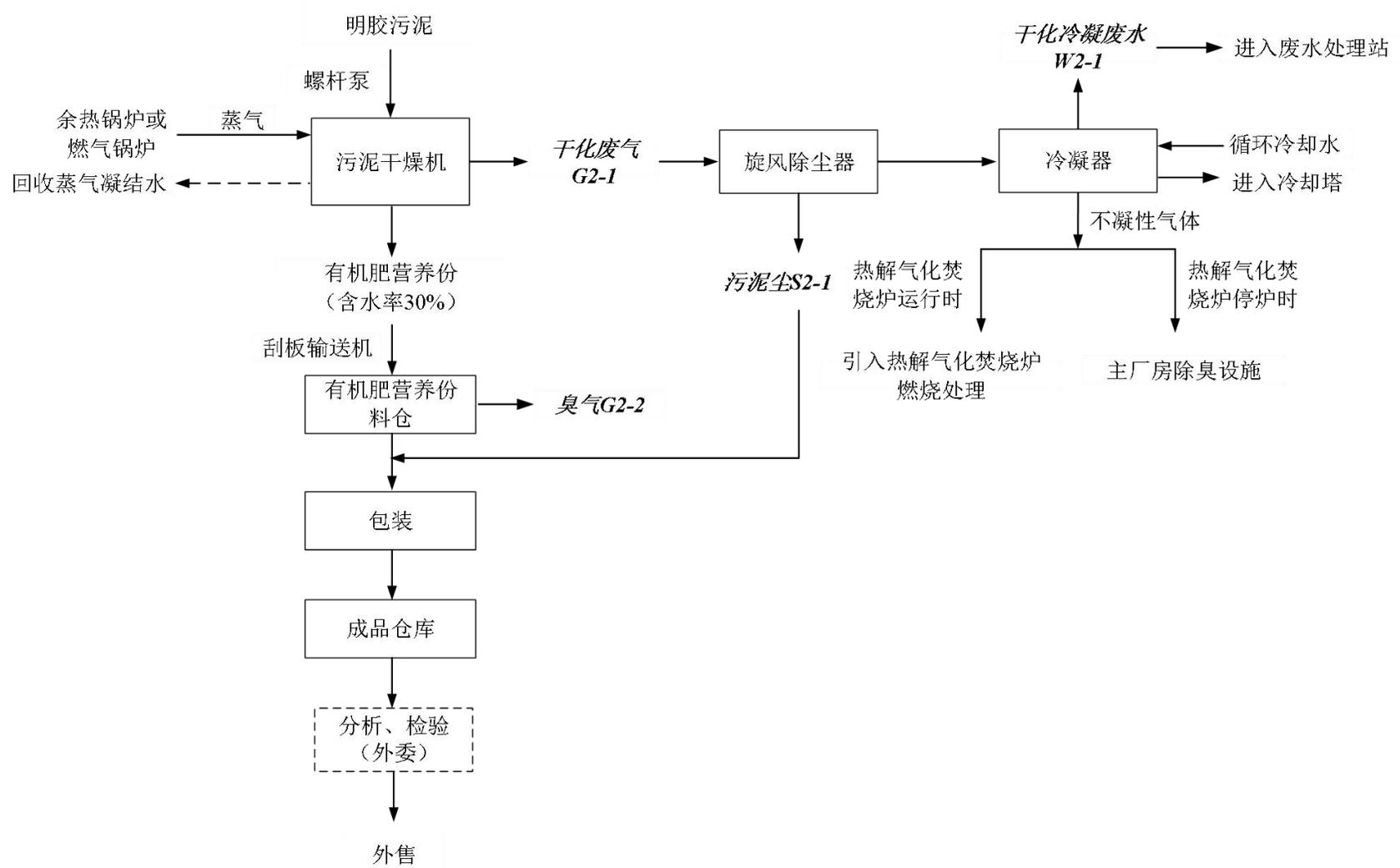
图 4.6-5 (b) 明胶污泥干化处理工艺流程图
