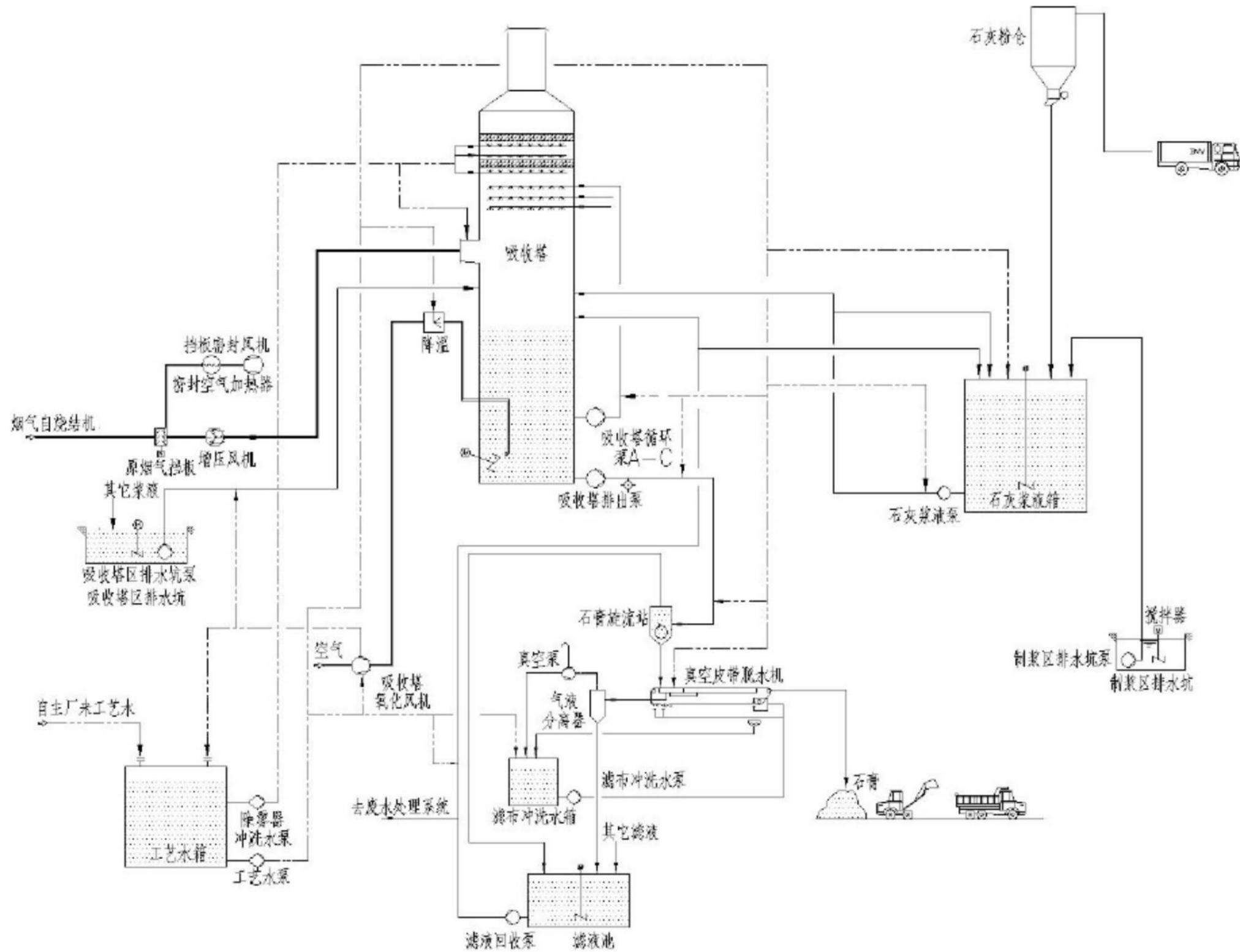
图 8.2-4 石灰-石膏湿法脱硫工艺流程图
