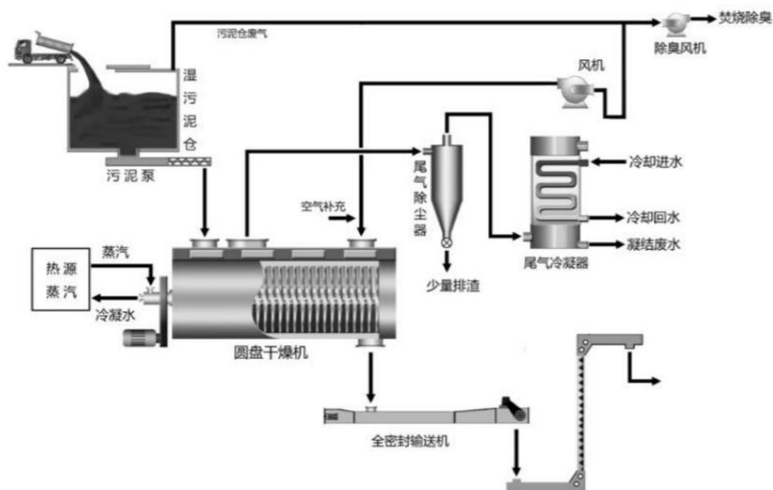
图 4.6-5 (a) 圆盘干燥机工作原理图
