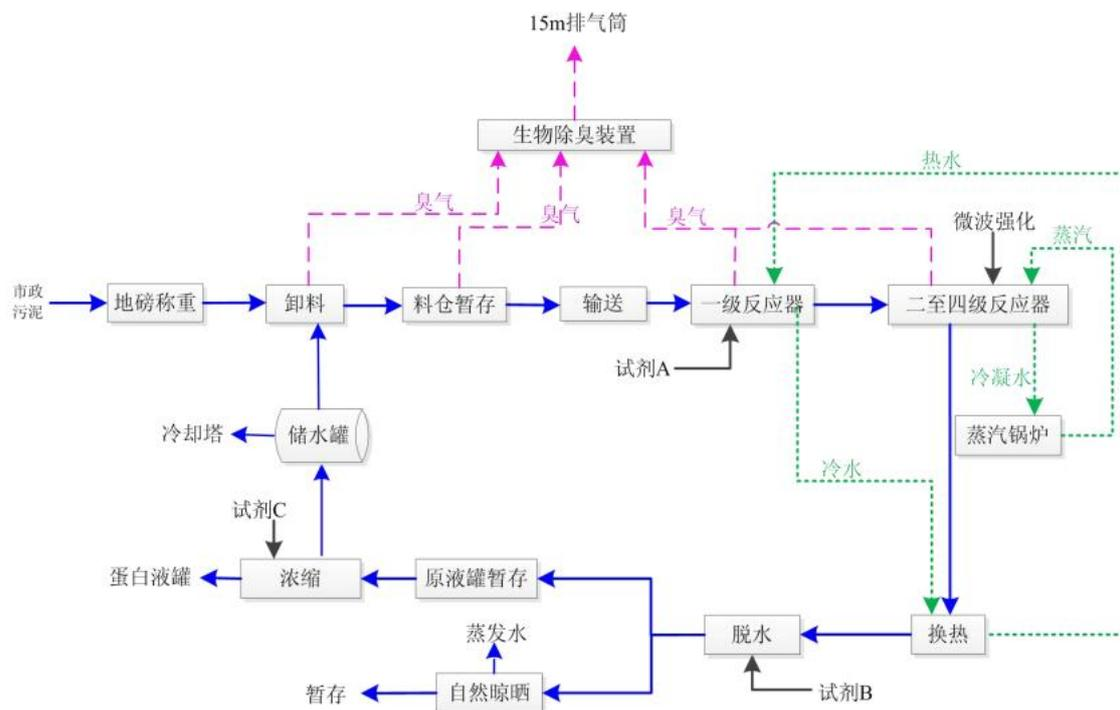
图 4.6-5 辽宁瑞博斯葫芦岛市污泥集中处置项目生产工艺流程图
