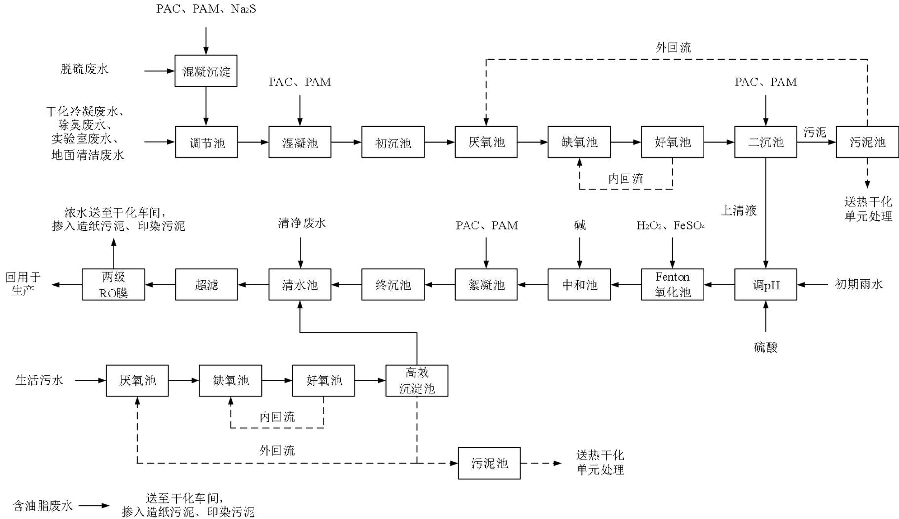
图 4.6-1 生产废水处理工艺流程图
