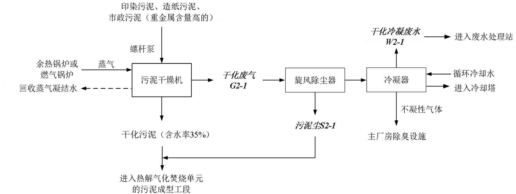
图 4.6-5 (a) 市政污泥、印染污泥、造纸污泥干化预处理工艺流程图
