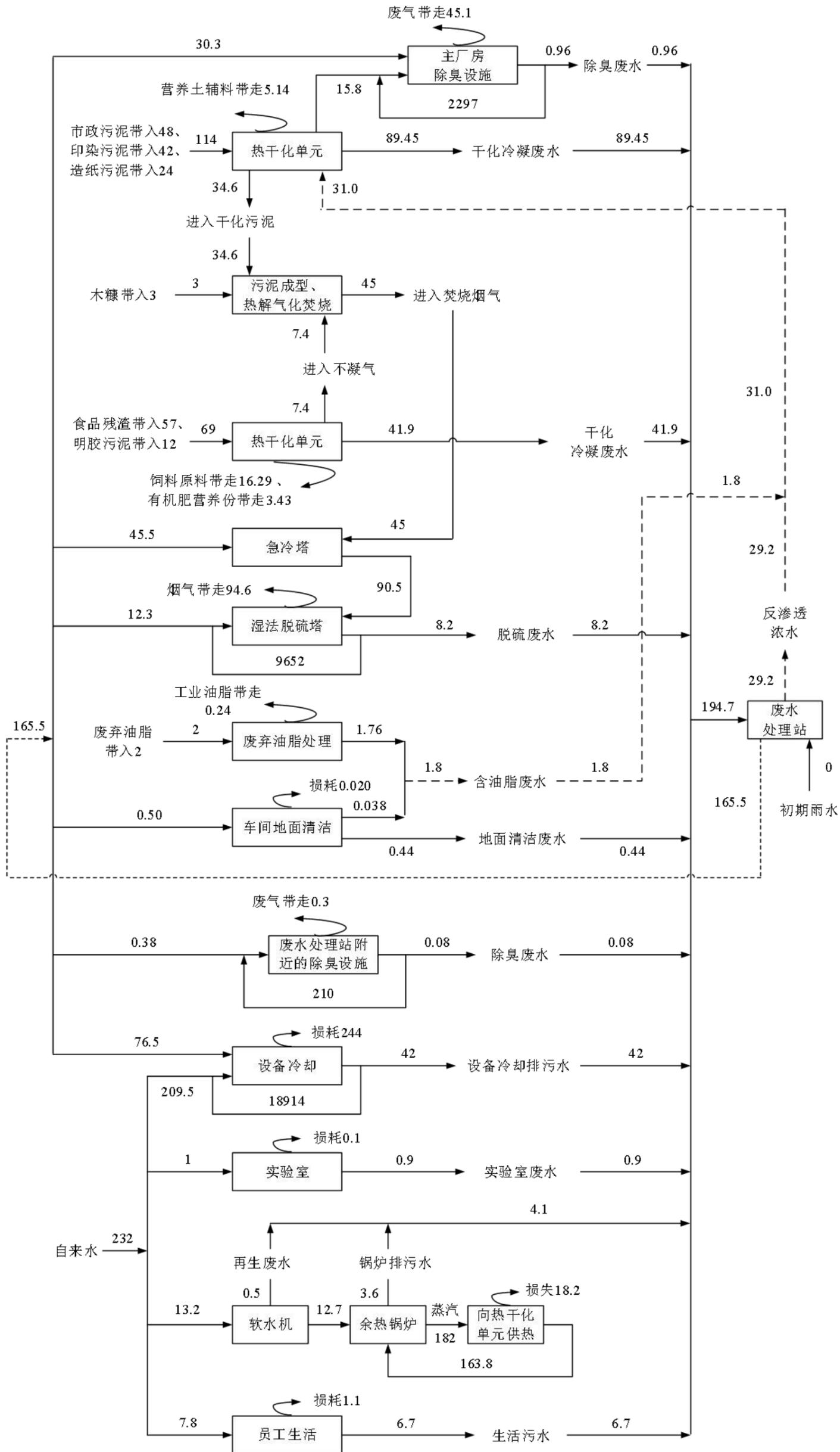
图 4.5-1 (a) 项目水平衡图 (晴天, 单位 m³/d)
