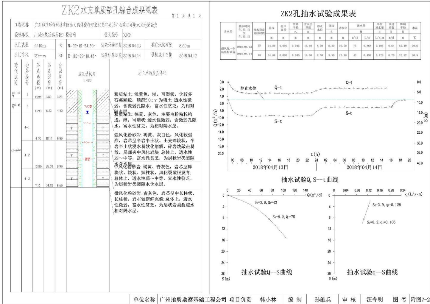
图 5.4-7 水文地质钻孔抽水试验成果图（ZK2）
