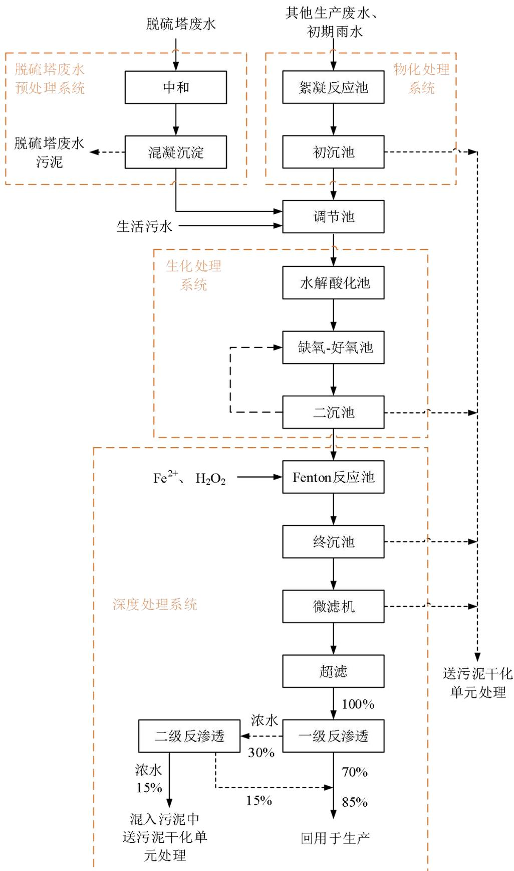
图 3.2-1 项目废水处理站工艺流程图
