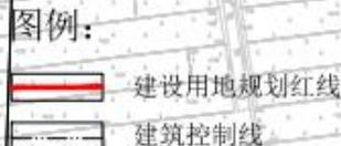
1. 图中所示建筑控制线为最低要求，具体须根据建筑体量及高度按规范要求退缩并须符合消防、交通等方面的要求。
